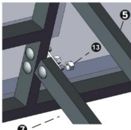
К полученной опорной конструкции прикрепите щит, используя комплект крепежей (13).
