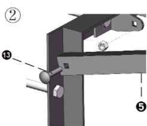
Закрепите на раме детали (5) и (7) при помощи четырёх комплектов крепежей (13).
