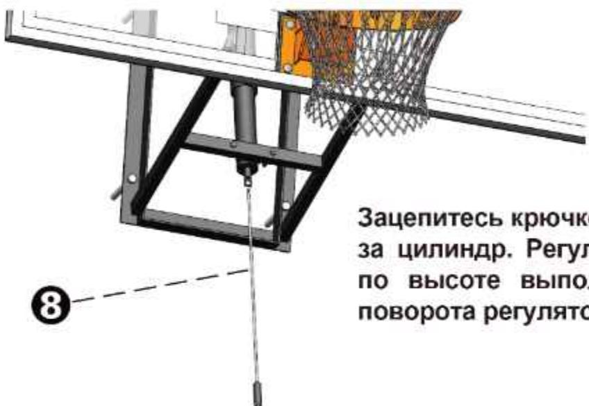
Зацепитесь крючком регулятора (8) за цилиндр. Регулировка системы по высоте выполняется за счёт поворота регулятора.
