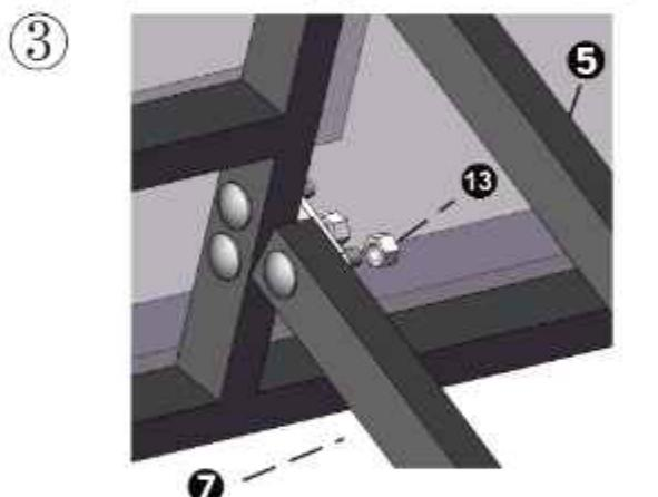
К полученной опорной конструкции прикрепите щит, используя комплект крепежей (13).
