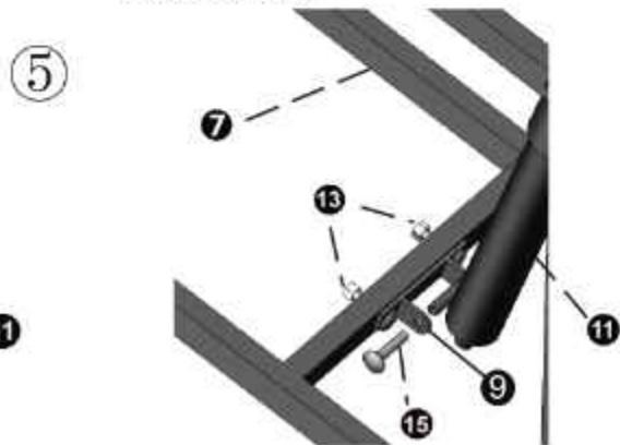
Закрепите кронштейн (9) на опоре (7) при помощи крепежей (13), а затем зафиксируйте в кронштейне цилиндр (11), используя крепёж (15).
