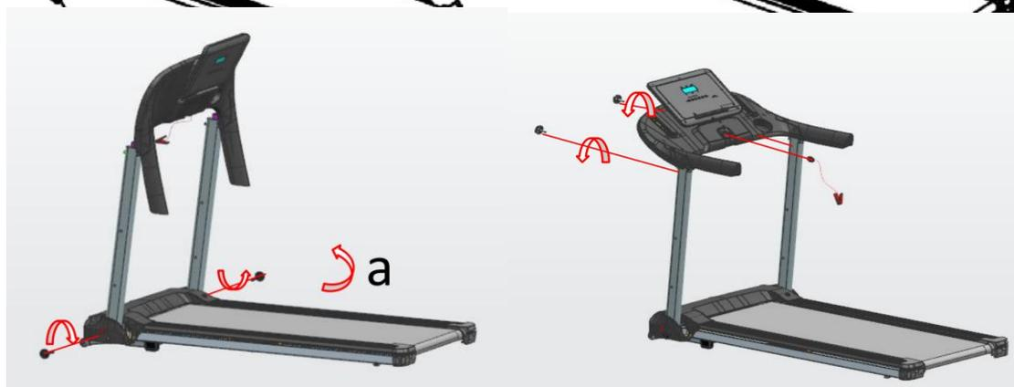
Завершите крепление при помощи винтов М8\*40 и М8\*65, шайб и гаек М8.
