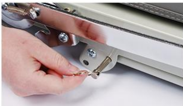
9. Выньте штифты из задней ножки.
