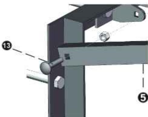
Закрепите на раме детали (5) и (7) при помощи четырёх комплектов крепежей (13).
