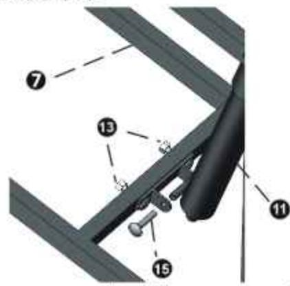
Закрепите кронштейн (10) на опоре (7) при помощи крепежей (13), а затем зафиксируйте в кронштейне цилиндр (11), используя крепёж (15).
