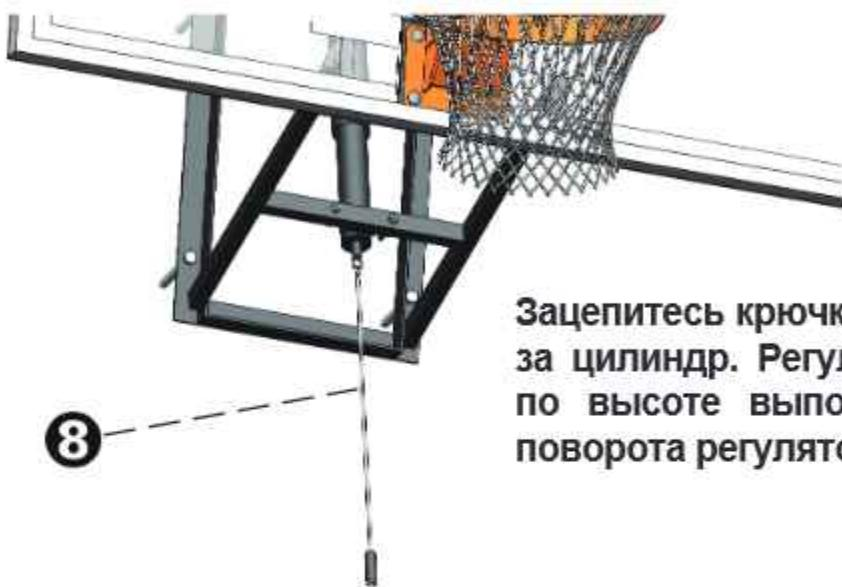
Зашептесь крючком регулятора (8) за цилиндр. Регулировка системы по высоте выполняется за счёт поворота регулятора.
