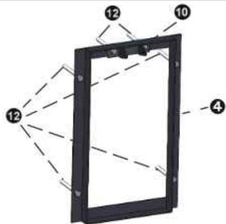
Просверлите в стене отверстия и закрепите раму (4) стойки при помощи кронштейна (10) и шести винтов (12).
