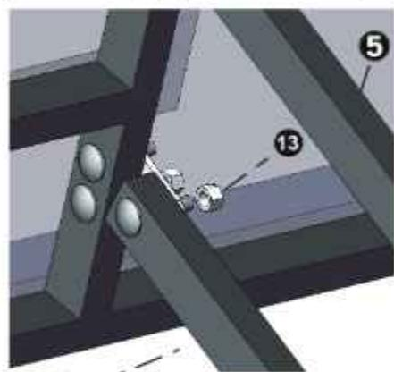
К полученной опорной конструкции прикрепите щит, используя комплект крепежей (13).
