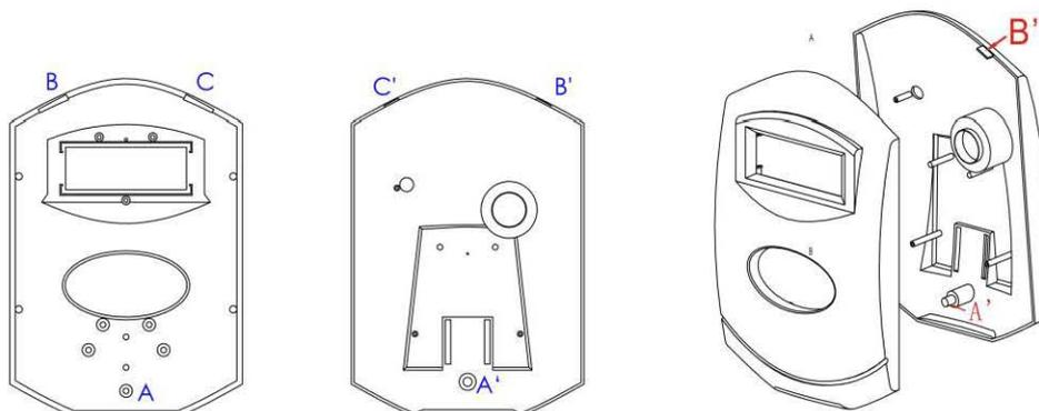
Сборка консоли: Вначале отрегулируйте положение крышек, выступы A' и A должны располагаться напротив друг друга. Затем соедините крышки таким образом, чтобы выступы B' и C' совместились с отверстиями B и C. Сдавите крышки до щелчка.
