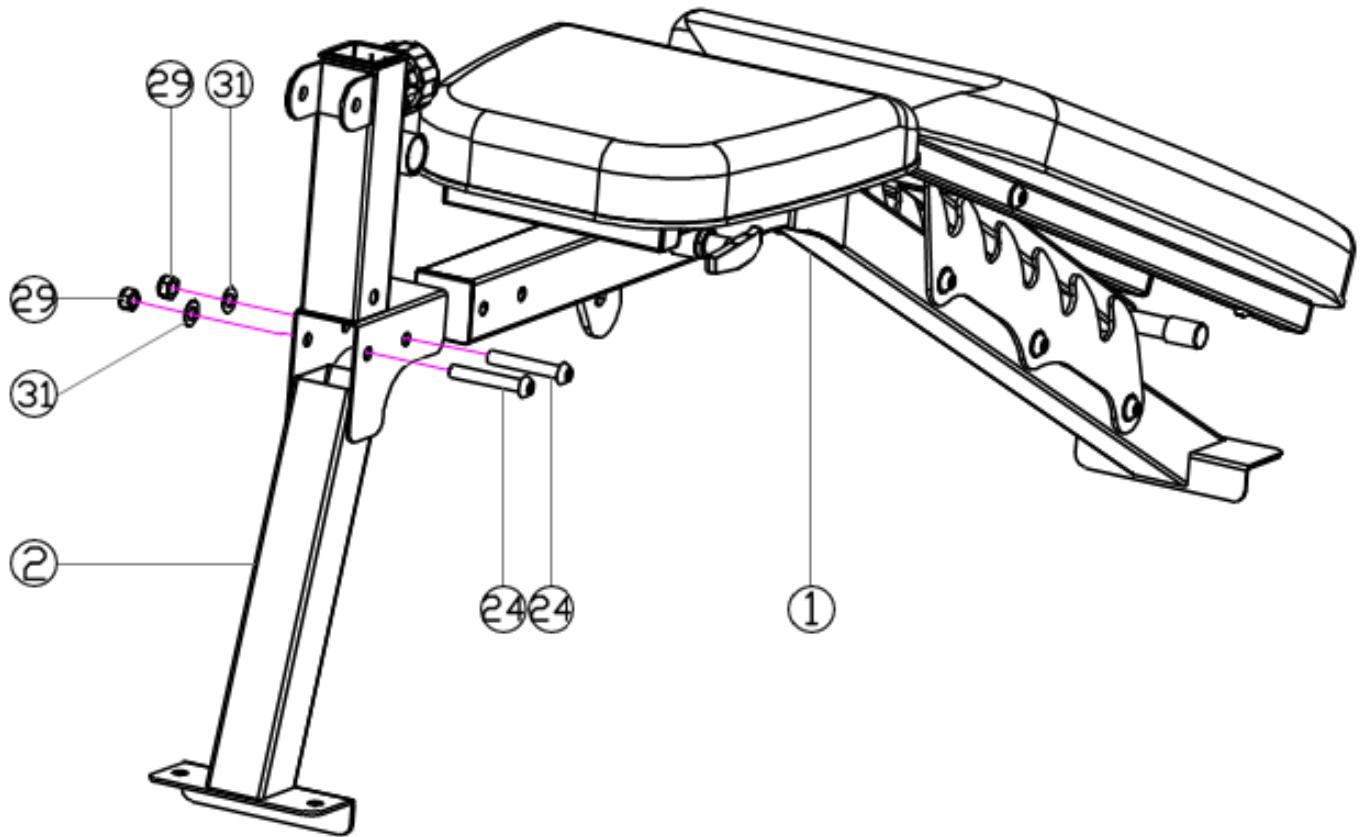
Для установки передней опоры (2) на основную раму (1) используйте 2 гайки M10 (29), 2 шайбы (31) и 2 шестигранных болта M10\*65 (24). Используйте гаечный ключ с #13-17 (A) и шестигранный ключ #6 (B), чтобы закрутить гайки по часовой стрелке.
