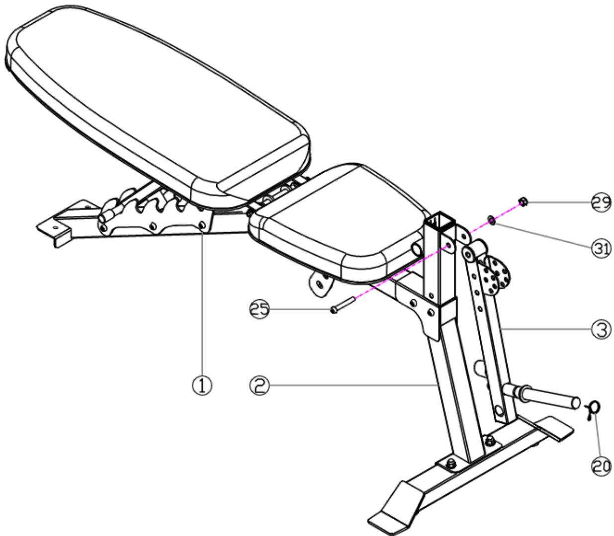
Закрепите переднюю стойку (3) на передней опоре (2) с помощью 1 болта М10\*60 (25), 1 шайбы (31) и 1 гайки М10 (29). Используйте гаечный ключ #13-17 (A) и шестигранный ключ # 6 (B). Наденьте кольцо ф25 (20) на переднюю стойку (3).
