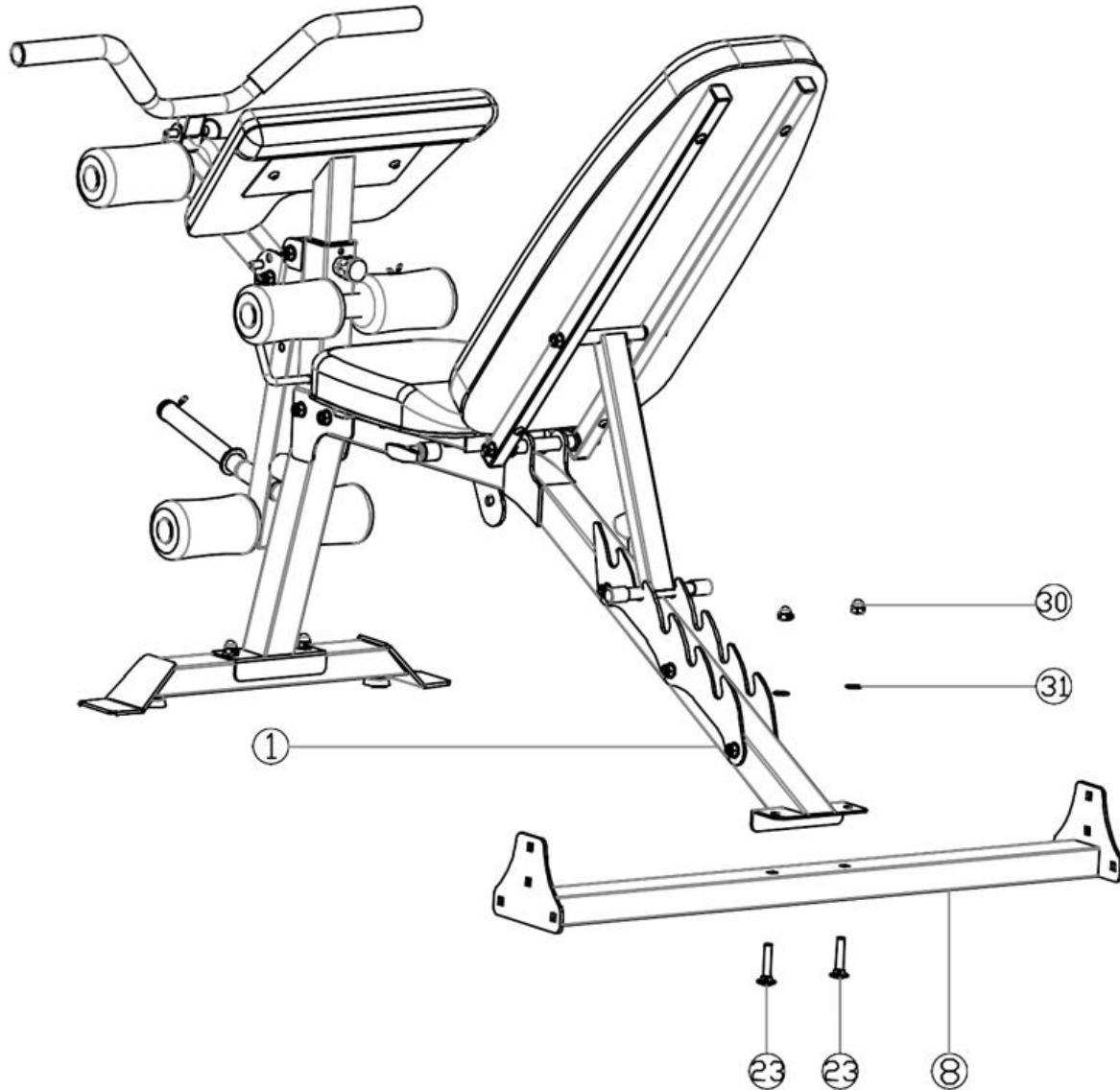
Закрепите соединение силовой рамы (8) на основной раме (1) с помощью 2 болтов M10\* 50 (23), 2 шайб (31) и 2 гаек M10 (30). Используйте гаечный ключ 13-17 (A), чтобы закрутить гайки по часовой стрелке.
