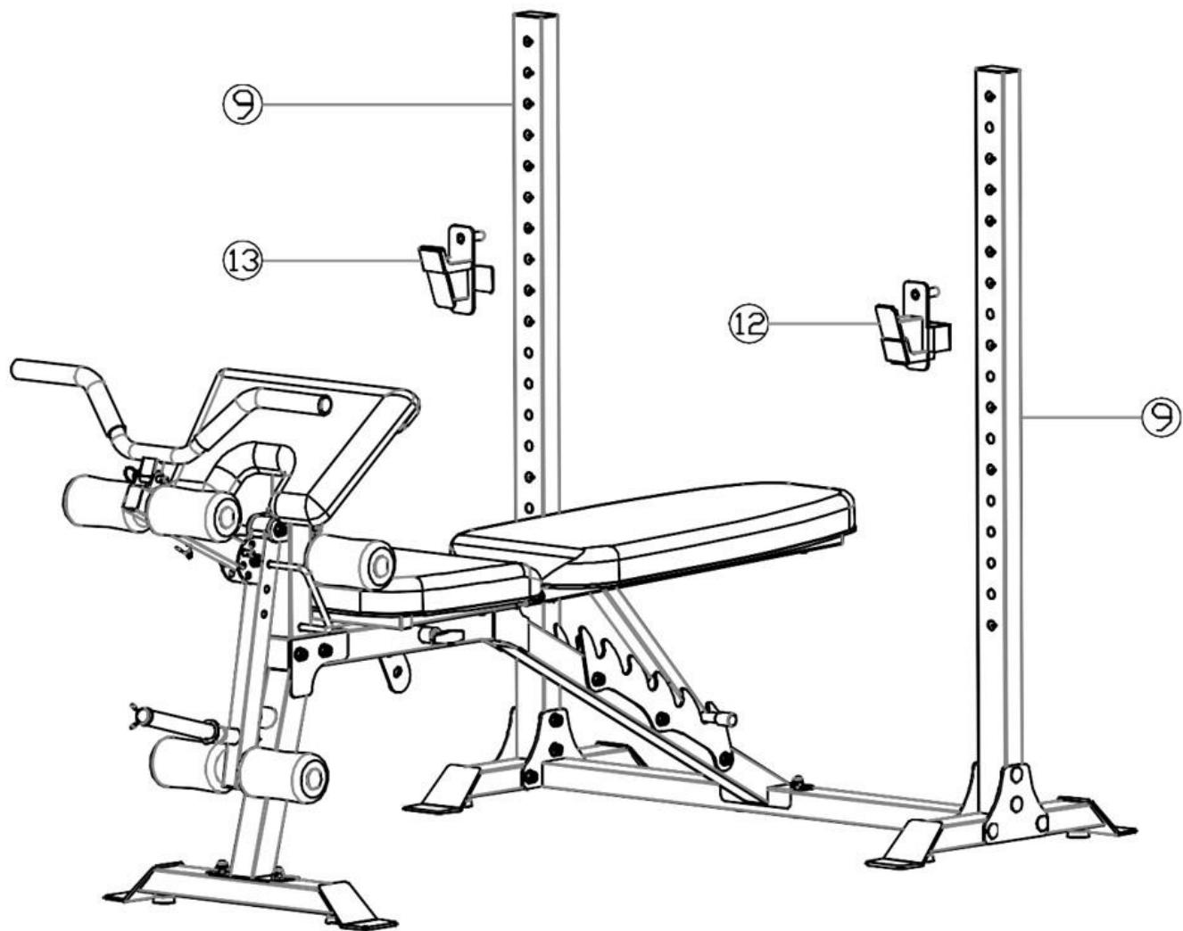
Держатель для грифа правый (12) и держатель для грифа (13), могут быть вставлены в разные отверстия для регулировки положения штанги по высоте.
