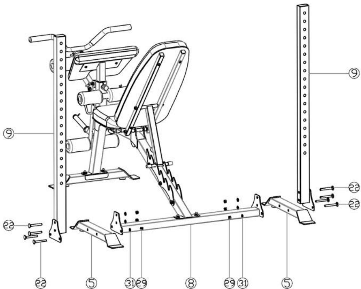
Закрепите задние стабилизаторы (5) на соединении силовой рамы (8), как показано на рисунке, с помощью 8 болтов M10\*80 (22), шайбы (31) и гайки M10 (29). Используйте гаечный ключ 13-17 (A), чтобы закрутить гайки по часовой стрелке и зафиксировать их симметрично с обеих сторон..
