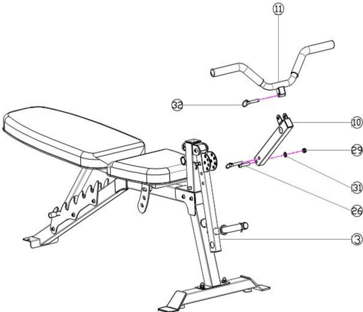
Вставьте переднюю регулировочную стойку (10) в переднюю стойку (3), затем с помощью шестигранного болта M10\*50 (26) проденьте переднюю регулировочную стойку (10) и переднюю стойку (3). С помощью гаечного ключа (A) и шестигранного ключа #6 (B) закрепите шайбу (31) и гайку M10 (29), и, наконец, вставьте штифт ф10\*55 (32) для фиксации. Вставьте поручень (11) в переднюю регулировочную стойку (10) и закрепите ее с помощью штифта (32). Вытяните штифт .
