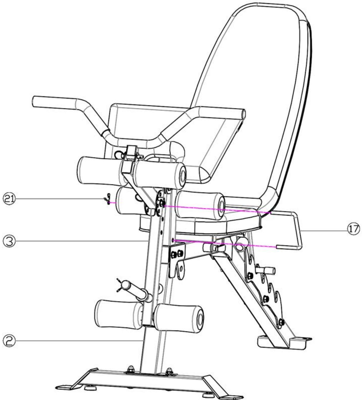
Возьмите крючок (17), как показано на рисунке, и вставьте отверстия в разных положениях, чтобы отрегулировать положение передней стойки (3) и лучше соответствовать эргономичному размеру. Кроме того, кольцо (21) установите на крючке (17) на предельной планке.
