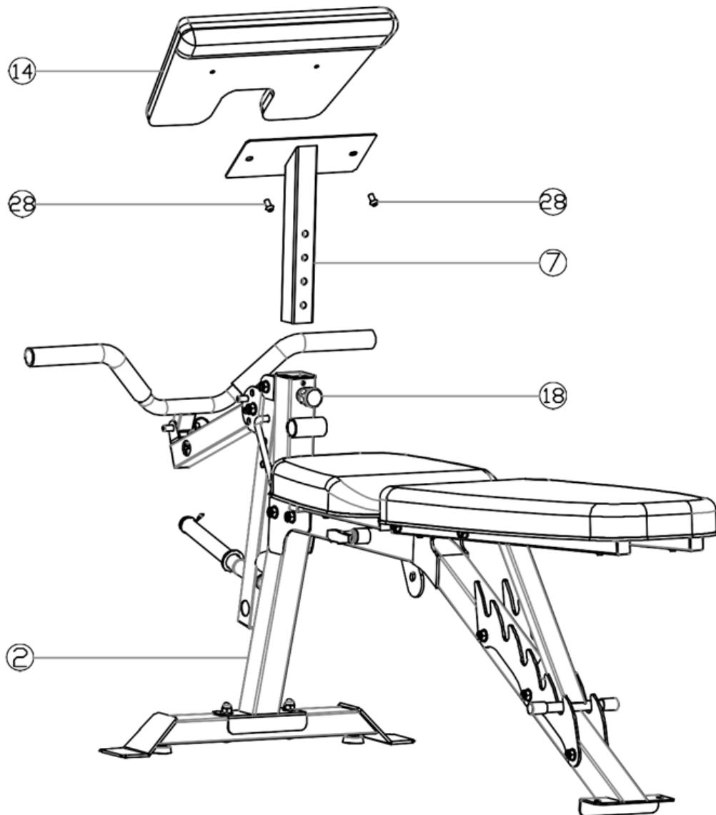
Совместите отверстия у опоры для рук (14) и у стойки (7) и закрепите с помощью 2х шестиграных болтов M8\*15 (28) и шестигранного ключа #5 (C) по часовой стрелке. Вставьте ручку (18) в переднюю опору (2), вставьте стойку (7) в переднюю опору (2), установите соответствующий уровень и поверните ручку (18) для фиксации.
