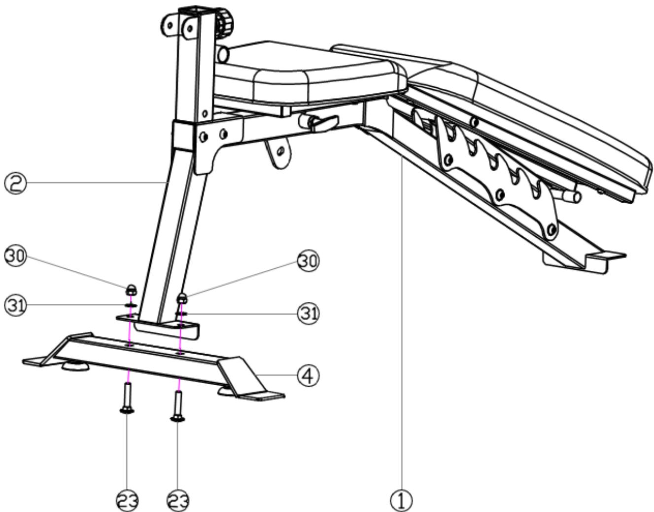
Установите передний сабилизатор (4) переднюю опору (2), используя 2 болта M10\*50 (23), 2 шайбы (31) и 2 M10 (30), зафиксируйте по часовой стрелке с помощью гаечного ключа #13-17 (A).
