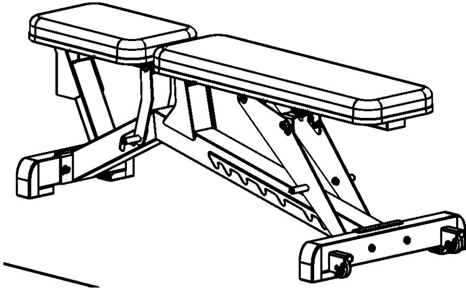
Достаньте основную раму в сборке (1), задний стабилизатор (3), 2 втулки (4), два шестигранных болта M8\*65 (5), 2 гайки M8 (6), 4 плоских шайбы d8\*D16 (7).
