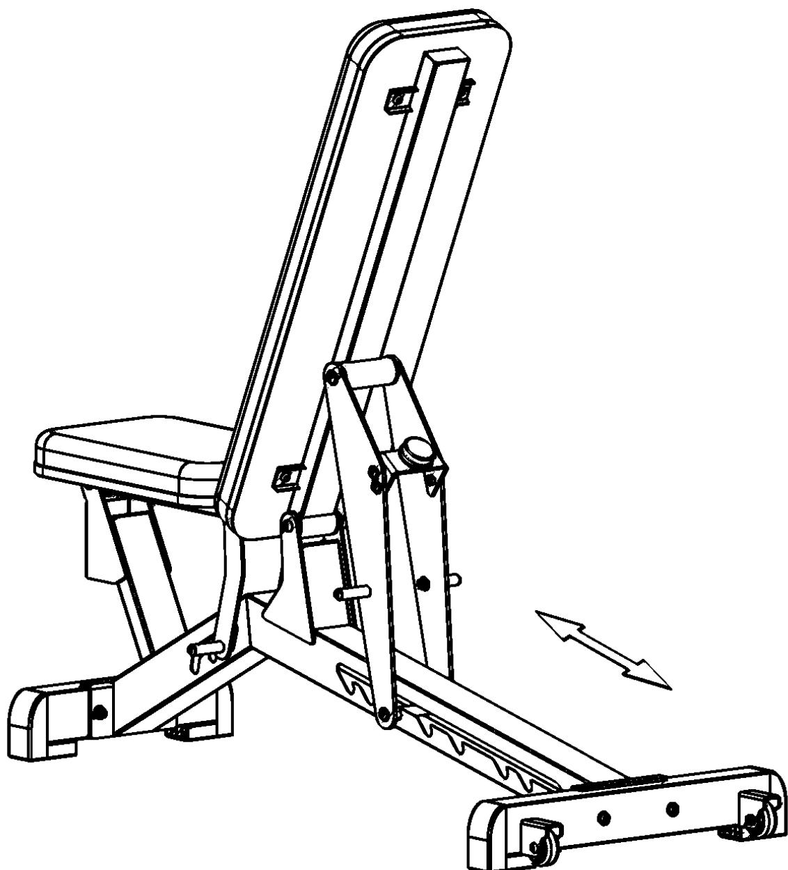
На задней основной раме имеется восемь фиксаторов.
