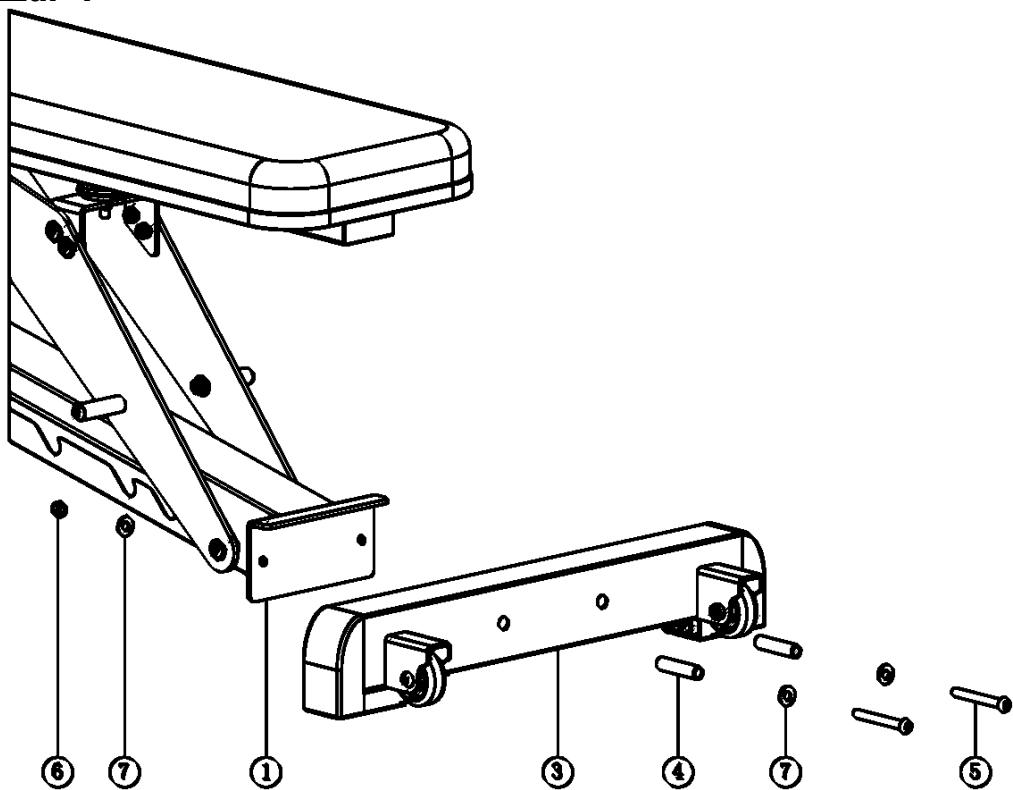
Как показано на рисунке, установите задний стабилизатор (3) на основную раму (1) и выровняйте отверстия, чтобы закрепить детали с помощью шестигранного болта M8\*65 (5), плоской шайбы d8\*D16 (7), втулки (4) по порядку, затем установите плоские шайбы d8\*D16 (7) соответственно. Крепко закрепите все детали с помощью гайки M8 (6).
